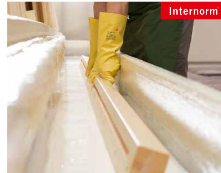
Wird der zusammengebaute Rahmen imprägniert gibt es keinen Schutz im Bereich der Verbindungen.
