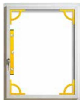
Der verschweißte Flügelrahmen wird winkelig gespannt.
