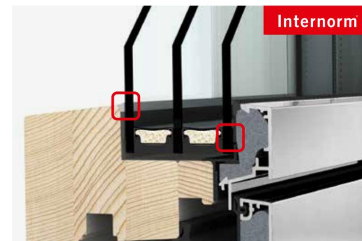
Die Verglasung ist von der Rauminnenseite dicht, daher kann keine feuchte Raumluft eindringen und das Holz schädigen.
